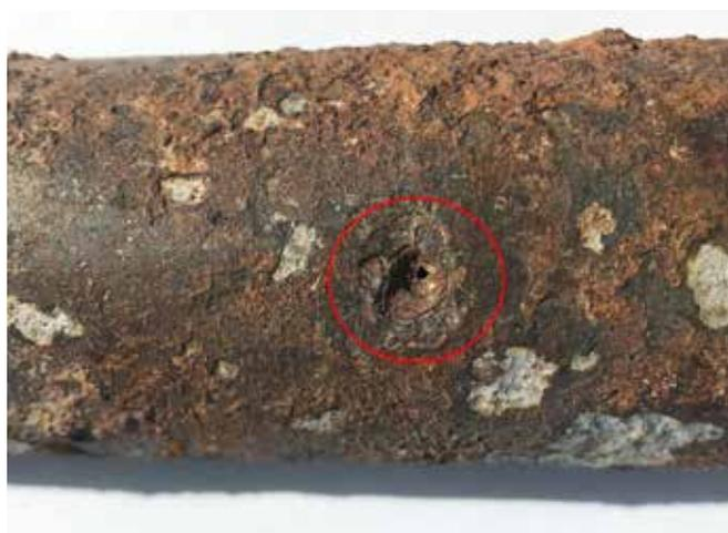
*Abgerissenes Rohr und Lochfrass, welche in dieser Dimension zu Wasserverlusten von mehreren Litern/Sekunde führen*
